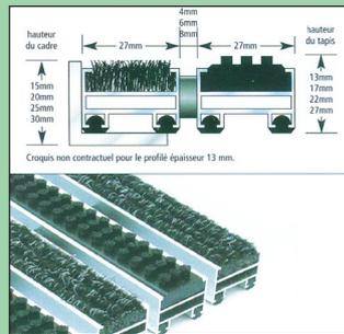
Matériaux : profilé aluminium rigide, résistant au gauchissement. Surface : côtelée résistante aux UV, fibres polypropylène, en alternance avec profilés brosse caoutchouc.
