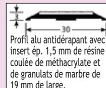
Profil alu antidérapant avec insert ép. 1,5 mm de résine coulée de méthacrylate et de granulats de marbre de 19 mm de large.
