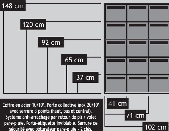
Coffre en acier 10/10°. Porte collective inox 20/10° avec serrure 3 points (haut, bas et central). Système anti-arrachage par retour de pli + volet pare-pluie. Porte-étiquette inviolable. Serrure de sécurité avec obturateur pare-pluie - 2 clés.
