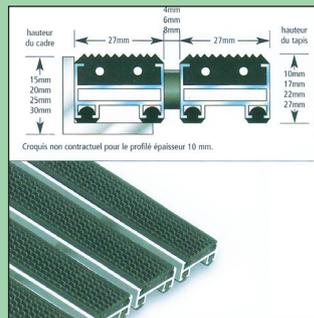
Matériaux : profilé aluminium rigide, résistant au gauchissement. Surface : caoutchouc strié dans les deux sens (EPDM), résistant aux UV (norme DIN 7863), norme anti-dérapante R9 d'après DIN 51130.
