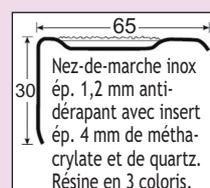
Nez-de-marche inox ép. 1,2 mm antidérapant avec insert ép. 4 mm de méthacrylate et de quartz. Résine en 3 coloris.
