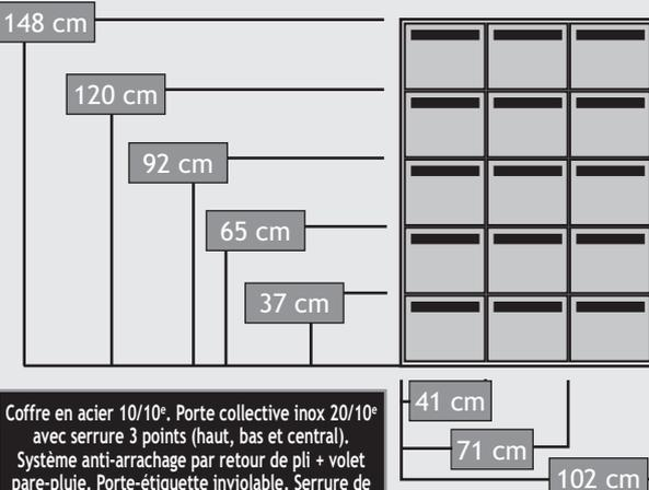
Coffre en acier 10/10°. Porte collective inox 20/10° avec serrure 3 points (haut, bas et central). Système anti-arrachage par retour de pli + volet pare-pluie. Porte-étiquette inviolable. Serrure de sécurité avec obturateur pare-pluie - 2 clés.
