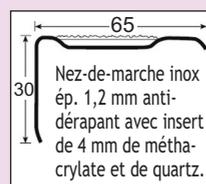
Nez-de-marche inox ép. 1,2 mm antidérapant avec insert de 4 mm de méthacrylate et de quartz.
