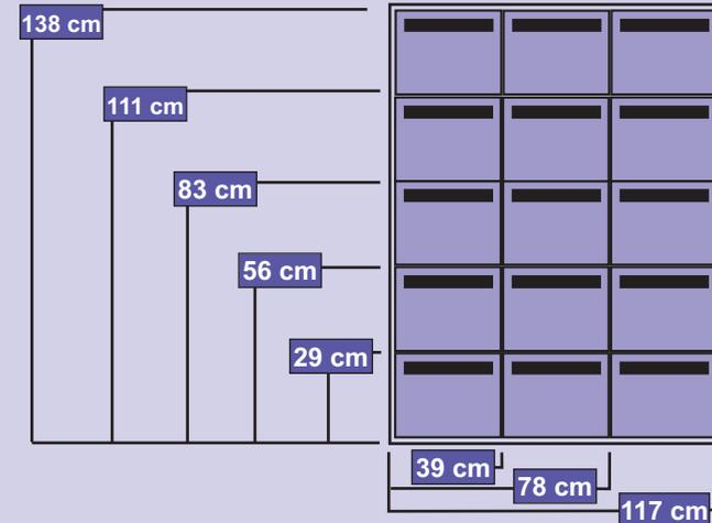
Coffre en acier épaisseur 10/10°. Portillon individuel, ouverture à la française, en acier épaisseur 15/10°. Verrouillage 1 point. Système anti-arrachage par retour de pli. Serrure de sûreté - 2 clés - Porte-étiquette. *Voir teintes métal ci-dessous.*
