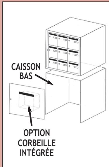
Les caissons bas sont fermés et adaptés aux blocs de boîtes aux lettres sur 1, 2 ou 3 colonnes de boîtes
