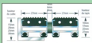
Matériaux : profilé aluminium rigide, résistant au gauchissement. Surface : caoutchouc strié dans les deux sens (EPDM), résistant aux UV (norme DIN 7863), norme anti-dérapante R9 d'après DIN 51130.
