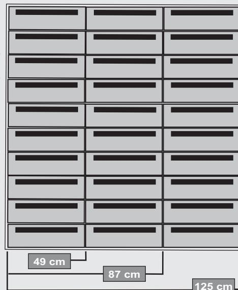
Coffre en acier épaisseur 10/10°. Porte collective acier 15/10° avec serrure. Portillon individuel, ouverture à la française, en acier épaisseur 15/10°. Verrouillage 1 point. Système anti-arrachage par retour de pli. Serrure de sûreté - 2 clés - Porte-étiquette.
