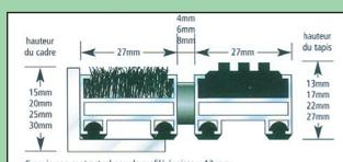
Matériaux : profilé aluminium rigide, résistant au gauchissement. Surface : côtelée résistante aux UV, fibres polypropylène, en alternance avec profilés brosses caoutchouc.
