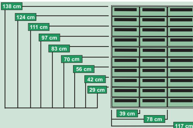
Coffre en acier épaisseur 10/10°. Portillon individuel, ouverture à la française, en acier épaisseur 15/10°. Verrouillage 1 point. Système anti-arrachage par retour de pli. Serrure de sûreté - 2 clés - Porte-étiquette. *Voir teintes métal ci-dessous.*
